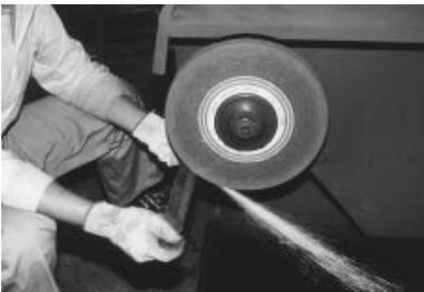
圖五 砂輪研磨劍胚
