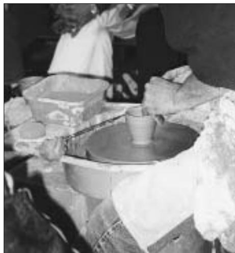
圖10：拉製固定尺寸作品的方法(二)——使用定位工具，定出其高度及寬度，將口緣直接拉至定位點即可。
