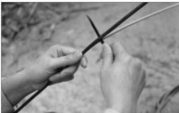
可用一小段外殼(圓面向下平面向上)撐開，右手往下壓，左手往上推
