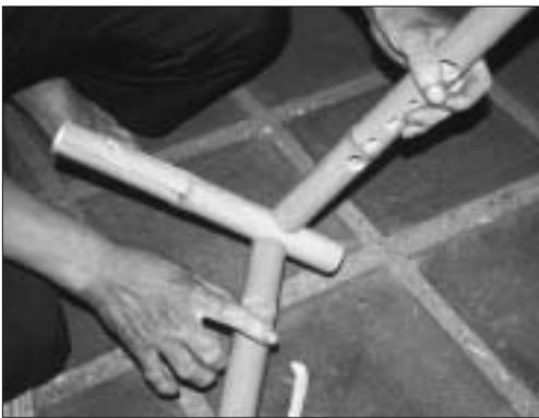
將已加熱軟化的包管孔彎曲
