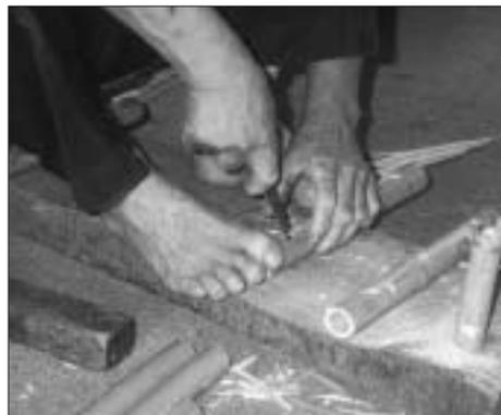
將鑿好的椅面洞口用尖刀修整
