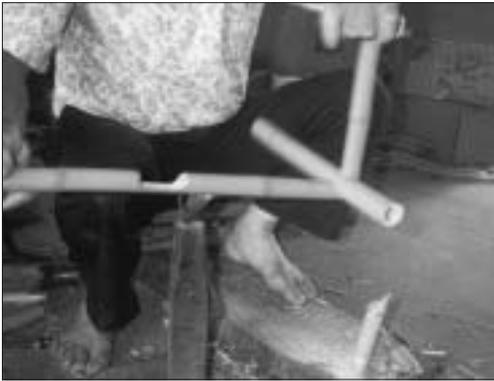
已挖薄的腳圍包管用火烤軟再彎曲
