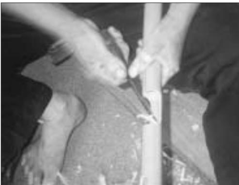
以挖鑿刀挖薄椅面包管之竹肉
