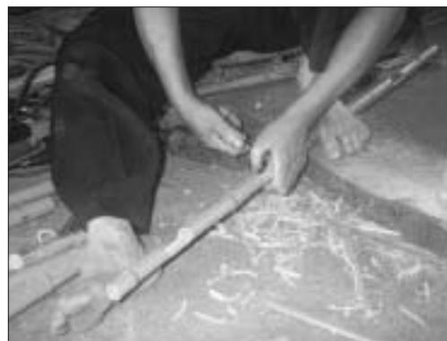
鑿修好弧度的包管緣口再用尖刀修整
