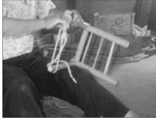
椅面包管幹與椅面框架組並用繩索暫時固定
