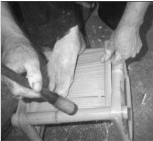
嵌入後的座面細竹片，另一頭再以壓條固定
