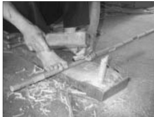
包管緣口用鑿刀修弧度
