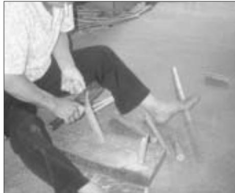
削去椅面框架要鑿洞之位子，使椅面較密合
