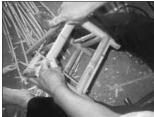
已用手電鑽打好的洞口再用竹釘固定
