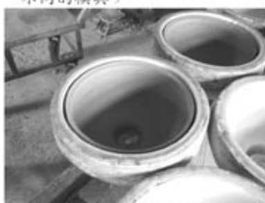
4. 陰乾後的土坯和石膏模分離，便可脫模
