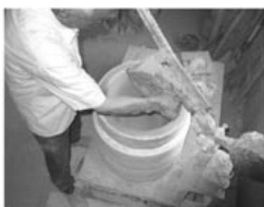
2. 壓下壓刀使土平均塗在旋轉中的石膏模上，並將多餘的土取出
