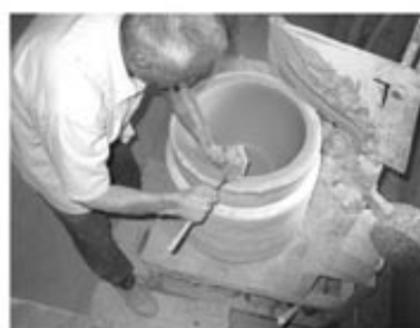
3. 用鐵片將口緣多餘的土刮除
