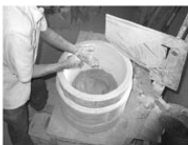
1. 將土倒入模具中（上下部分使用不同的模具）
