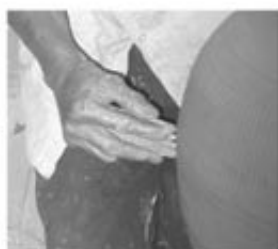
12. 用工具在接合處畫線，有強化及美化作用
