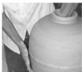
10. 將上下部分接合，並用手將接合處密合
