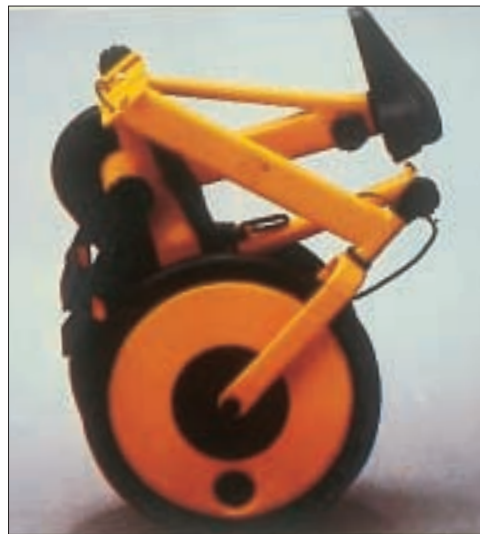
（圖八）摺疊式自行車摺疊後 近代
