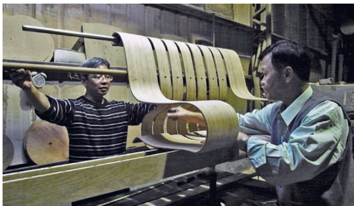
劉崑源（右）與張師傅（左）正進行組裝測試，檢查螺絲孔位的精準度。 （攝影／盧祥華）
