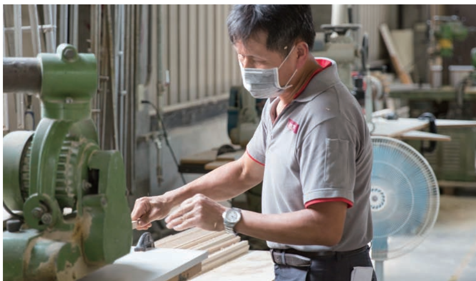
永進木器廠的立軸機，針對實木加工設定的生產線，老師傅能自行製作模具、夾具與木工工具；主要是執行小物件的取形、洗溝與倒角。
