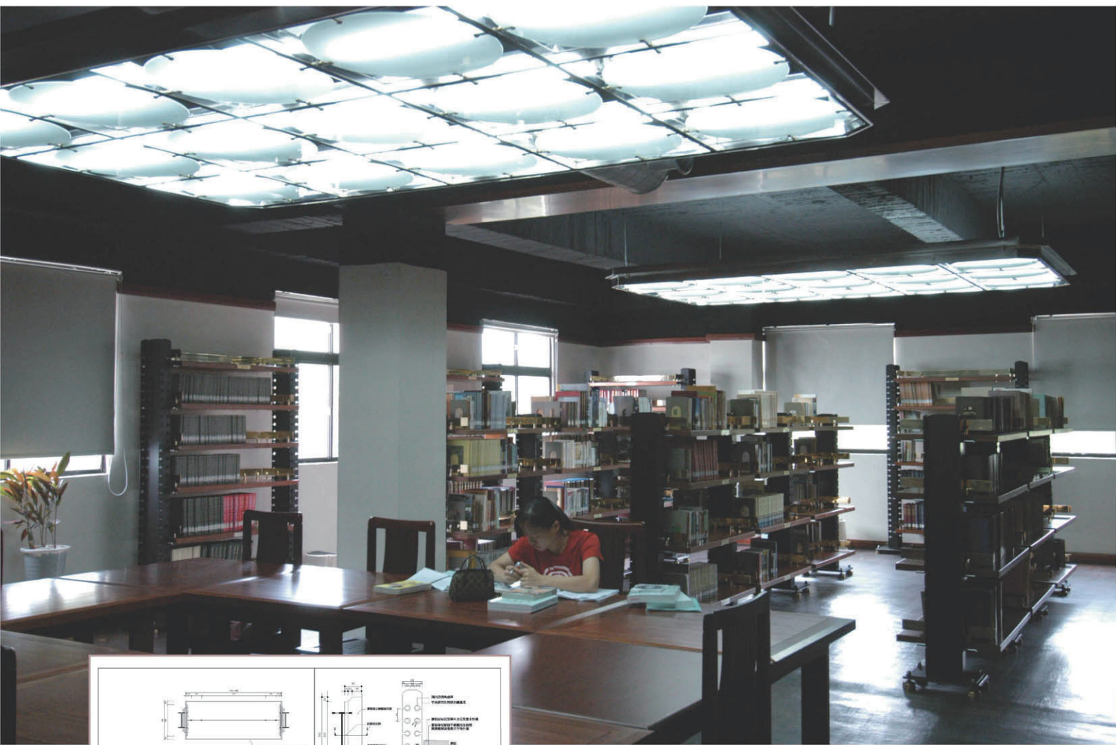
台南縣政府南瀛圖書館內的南瀛館資料室連結書架／盧圓華，2004。顯示一種充分活用榫卯工藝的複合材料書架，重要的可調整機構部位，即由獨具明示性的托架插梢所標定。運用的材料，包括：鋼鐵、不鏽鋼、銅板和花梨木。
