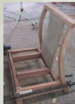
漢風賦形／盧圓華，2005。將構造系統和形式表情兩者相共構而烘托使用機能。座面被穿帶意象所彰顯，而榫卯接合的木構架形式語彙，清楚述說座椅的接地關係。
