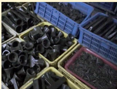
步驟 B2：蠟製零件
