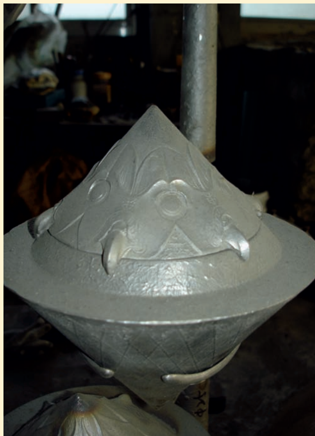
步驟 A4：不鏽鋼鑄造半成品
