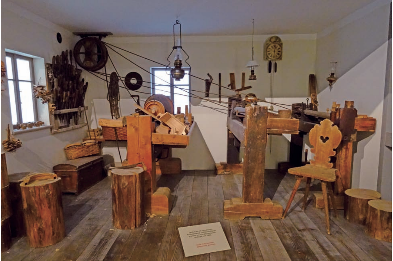
賽芬玩具博物館展示1880年左右玩具工坊的製作工具，早期的木製車床。
