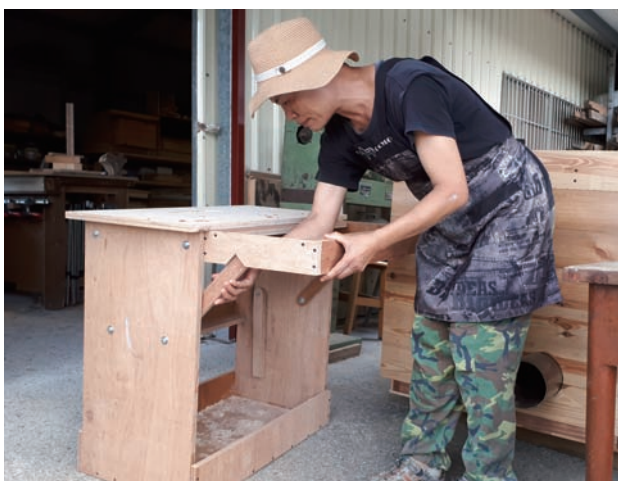
黃清泰自行開發製作木工操作設備，讓木工製作器具簡便易收納，提供木工愛好者更易上手的使用機具，圖為木工綜合機。
