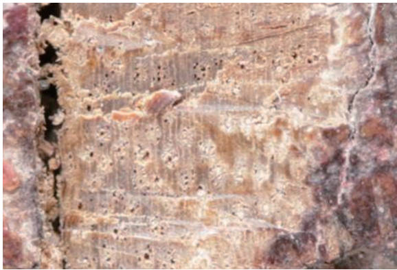
■ 圖 20. 導管孔斜向排列 Figure 20. Vessel arrangement in diagonal pattern 資料來源：作者提供
