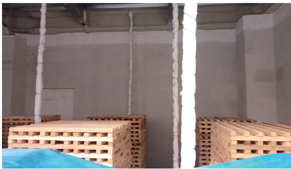
圖 7. 火場現場石材及感溫計配置圖 Fig 7. Positions of sample and thermometer 圖片來源：作者提供
