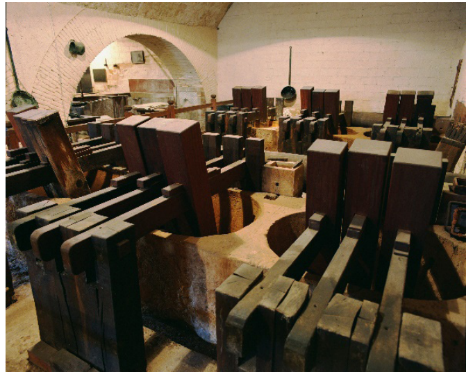
圖 5：加泰隆尼亞紙漿工廠博物館展示的紙漿捶打設備。紙張製造最早於十二世紀由西班牙傳入歐洲，是由入侵歐洲的伊斯蘭教勢力從中國引入，隨後又傳入義大利與其他國家。（圖片來源：Eusebi Casanelles）
