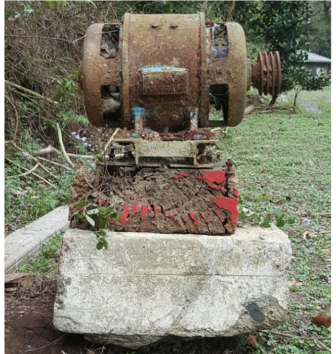
圖 2：位於扇平的挖掘工作發現了一座五千瓦的三項電發電機（3 phase 5kW generator），底下有木製防震墊與水泥底座
