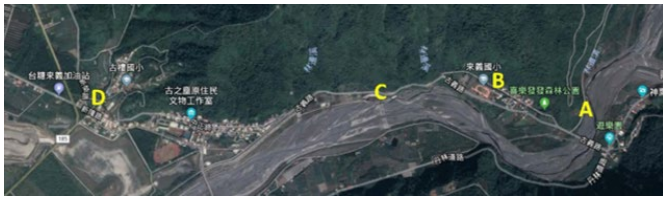
圖 4：林邊溪旁的集水建築分部。A 代表第二進水塔；B 代表渠道出水口和側向溢流堰（比如溢流道）；C 代表隧道出水口；D 代表分水工。（圖片來源：©2019 Google）
